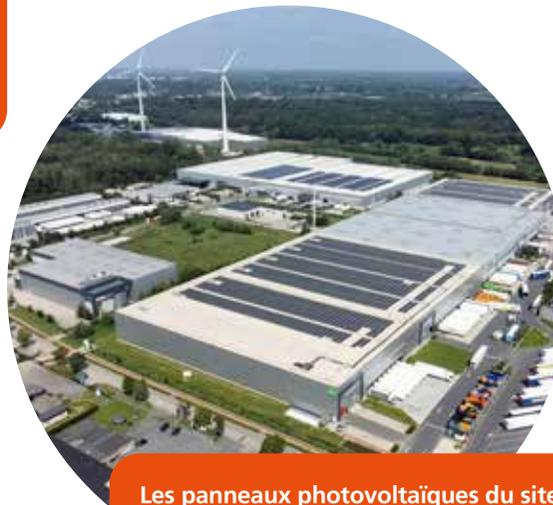
Les panneaux photovoltaïques du site de Puurs couvrent les toits sur environ 18 000 m<sup>2</sup>. La production annuelle est estimée à 2 746 MWh d'électricité.
