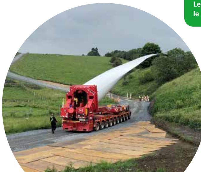
L'opérateur a réglé la hauteur de pale nécessaire pour passer au-dessus du talus. Des plaques en métal ont également été placées sur le bas-côté de la route, afin de permettre le passage du camion sans recourir à un empiérement permanent.
